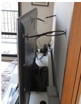
時々掃除のため外せるようリユースタイプを使用。見る角度をかえるため緩めの輪。
